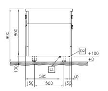
Electrical inlet (power) EQ **Equipotential screw**
